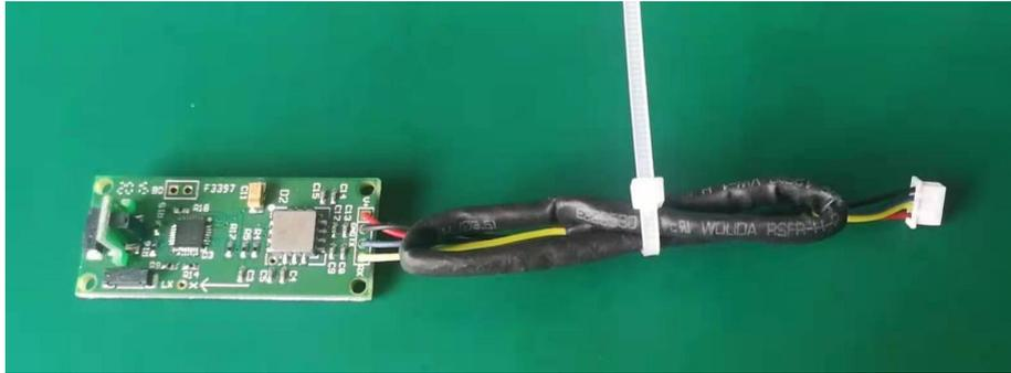
MCP-303 型电子罗盘由三轴磁传感器、加速度计和单片机等构成，内置航向角解算软件及铁磁校准软件，可实现自主（不依赖于 PC）对软/硬磁干扰进行补偿修正，具有较高的姿态测量精度。可为用户提供三维角度数据：航向角、俯仰角、横滚角。广泛应用于航空、航海、钻井测量、军事等需要定向和导航的领域。产品指标有如下特点：
