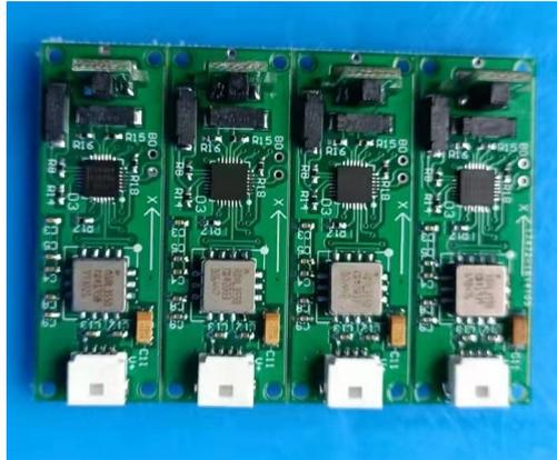
MCP-601 型电子罗盘由三轴磁传感器、加速度计和单片机等构成，内置航向角解算软件及铁磁校准软件，可实现自主（不依赖于 PC）对软/硬磁干扰进行补偿修正，具有较高的姿态测量精度。可为用户提供三维角度数据：航向角、俯仰角、横滚角。广泛应用于航空、航海、钻井测量、军事等需要定向和导航的领域。产品指标有如下特点：
